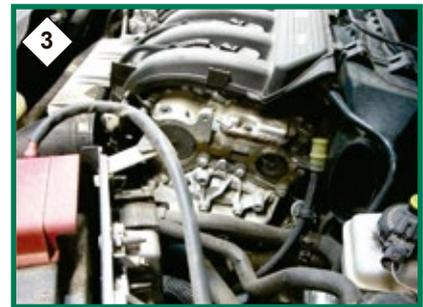
2. Retirar las bobinas y bujías. Esta operación es importante, pues la compresión del motor influencia en el correcto ajuste de la correa.
