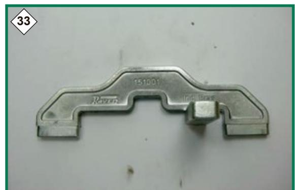
Enseguida después encaje nuevamente la Herramienta N° 151001, para trabar los ejes comandos; en caso que haya dificultad suelte el perno, Herramienta N°151005, y desplace el eje-cigüeñal hasta conseguir el encaje perfecto.
