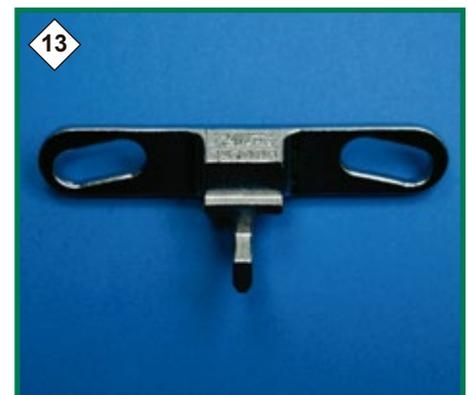
5. Retirar el tapón Torx (localizado en el bloque del motor en la cara dirigida hacia el radiador) y trabar el eje del cigüeñal a través de la herramienta N° 151005 (Perno posicionador para mantener el 1º cilindro en el punto muerto superior).
