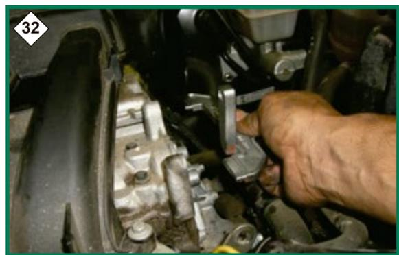
18. Aún con el autotensor en la posición de máxima tensión, con el puntero desplazado hacia la derecha, dar dos (2) vueltas en el eje-cigüeñal en el sentido de giro del motor (horario), para igualar las fuerzas tensionales en toda la correa dentada. Después de eso verifique nuevamente el fasaje del motor, esto es: si el perno, Herramienta N° 151005, encaja perfectamente para trabar el eje cigüeñal, para ello gire el eje hasta tocar en el perno.
