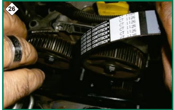
13. Instalar una llave Allen (6 mm) en el autotensor y girar en el sentido horario, hasta obtener la tensión máxima de la correa, trabar la tuerca con torque de 27 N.m (2,7 kgf.m). Observe que en esta posición, el puntero del autotensor estará a la derecha.
