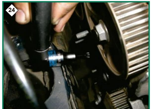
11. Montar el Autotensor, posicionando el resalte de su base en el alojamiento existente en la carcasa de la bomba de agua.
