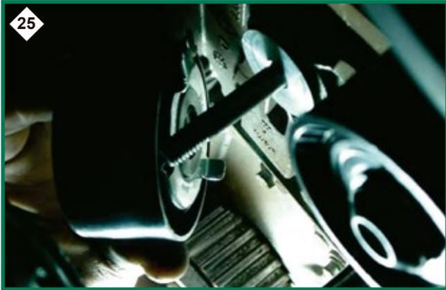
12. Colocar la correa dentada en el sentido anti-horario, colocar nuevamente la herramienta N° 151002 para trabar los engranajes de los comandos que están sueltos.
