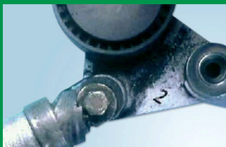
DAÑO EN LA TUERCA DE FIJACIÓN DEL TENSOR HIDRÁULICO
