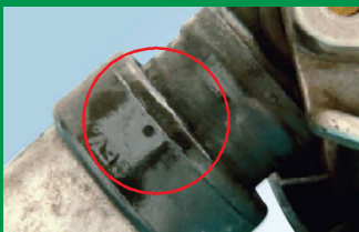
PERDIDA DE ACEITE EN EL RETÉN DEL TENSOR HIDRÁULICO
