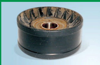
DESGASTE EXCESIVO EN POLEAS
