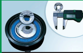
ROTURA DEL SOPORTE DE FIJACIÓN DE LA POLEA
