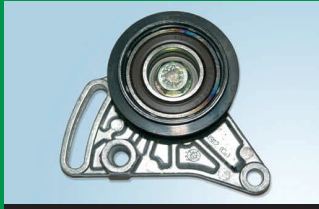
POLEA CON MARCAS DE COLOR AZUL/CAFÉ (SOBRE CALENTAMIENTO EN LA PISTA EXTERIOR)
