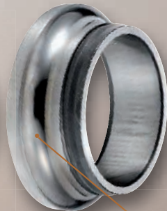
Ralladuras del anillo interior
